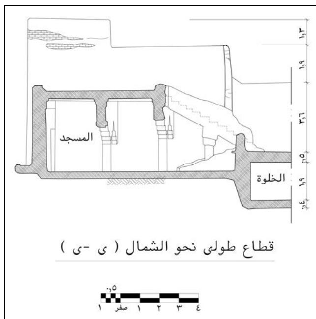
الشكل رقم (٨-ج). قطاع طولى بالمسجد والخلوة نحو الشمال يبين التفاصيل الداخلية (تحديث الرفع السابق لوكالة الآثار).
