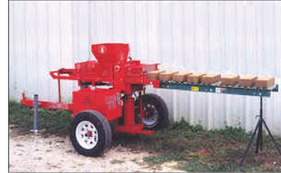
شكل ١٢- شكل ١٤: ماكينات لإنتاج عناصر للبناء يمكن نقلها إلى الموقع المصدر: (باهمام، ١٤٢٩)
