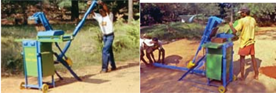
شكل ١- شكل ٢: ماكينة Auroville Earth Institute 3000 Press لإنتاج الطوب بالضغط اليدوي. المصدر: www.aureka.com
