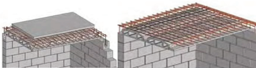
شكل ٣٢: وضع طبقة حديد وصب طبقة من الخرسانة فوقها
