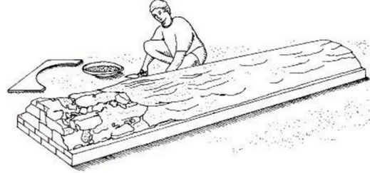
شكل ٢٢: عمل قوالب من الحجارة والاسمنت لتصنيع الوحدات القشرية
