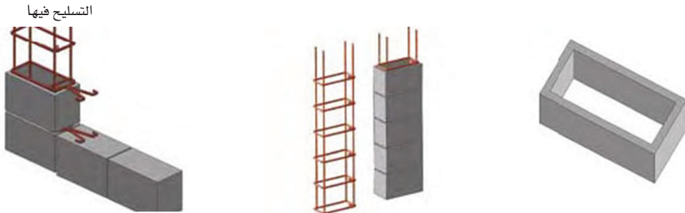
شكل ٢١: بلوكات مفرغة للأعمدة وطريقة التسليح وبناء الحوائط الملتحمة بالأعمدة
