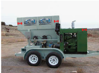
شكل ١٢- شكل ١٤: ماكينات لإنتاج عناصر للبناء يمكن نقلها إلى الموقع المصدر: (باهمام، ١٤٢٩)
