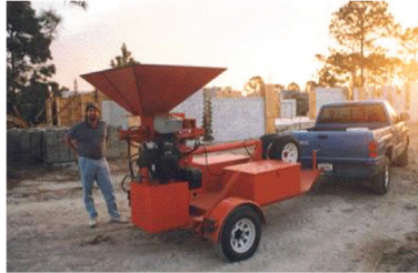
شكل ١٢- شكل ١٤: ماكينات لإنتاج عناصر للبناء يمكن نقلها إلى الموقع المصدر: (باهمام، ١٤٢٩)
