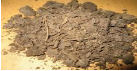
الشكل رقم (٦). يوضح شكل نفايات قصب السكر بعد طحنها جيداً- المرجع: (Setyowati,2014).
